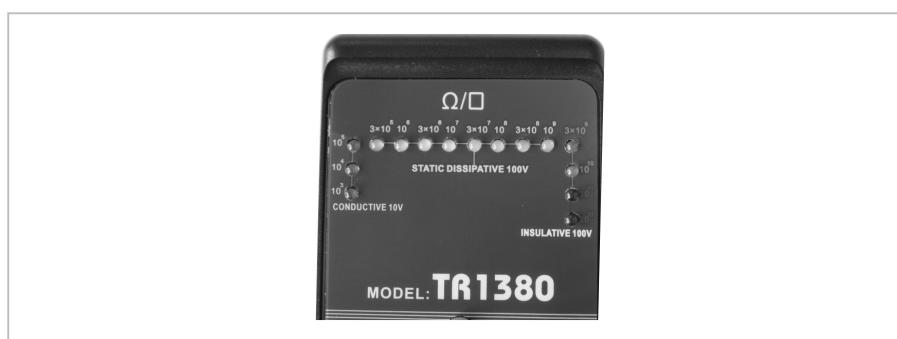
测试结果会通过LED显示，为了使测量数据更接近事实，设计上使用了 half decade 的显示方式。A decade会照应相应的测试结果，用颜色标出测试值的功能。
