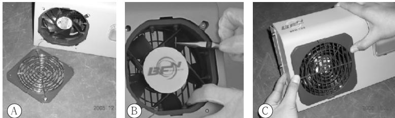
(A) 按照前罩的拆卸方式将面罩完全取下，并轻轻的放置在机体侧面，
