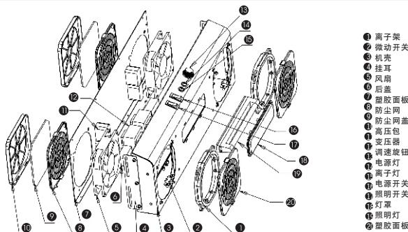
图一：BFN-702+直流离子风机结构图
