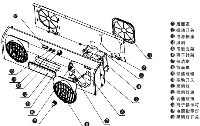
图一：BFN-802交流离子风机结构图
