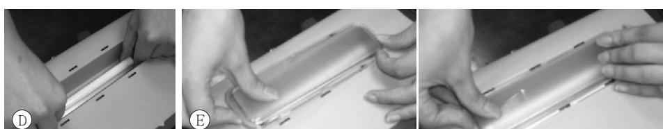
Ⓓ 使用双手握住新的照明灯管两端的金属部分，将其插入灯座中，轻轻转动90度，将照明灯安装在灯座内。
