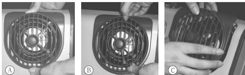
Ⓐ 将塑胶前面罩下部的卡扣向上按住，使卡扣与金属外壳脱离。
