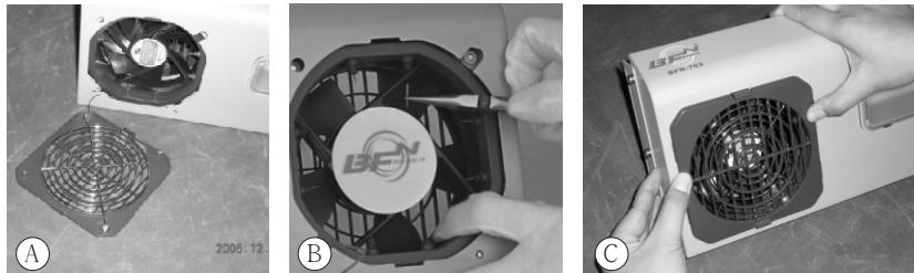
Ⓐ 按照前罩的拆卸方式将面罩完全取下，并轻轻的放置在机体侧面，
