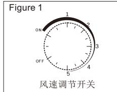
把设备固定位置后，插上电源插头，启动离子风机。将风速调节开关顺时针方向扭向ON位置，听到“啪”的一声轻响后风机已正常启动，同时可以看到调节器左上方的功能指示亮灯，表示离子发生器工作正常。
