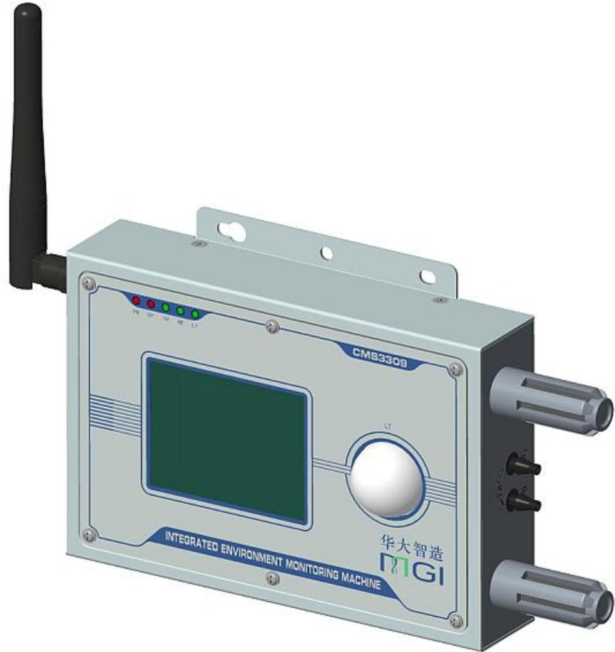
CMS3309 环境采集终端是一款多参数环境监测设备，可用于监测生物医药、电子制造等场所室内温度、湿度、噪声、压差、光照度、风速，设备的温度、湿度采用双探头备份机制，监测的温度、湿度值先经 MCU 对双备份传感器的数据进行内部的偏移及校准运算，其偏移量及算法修正后数据通过 WiFi 或 RS485 通信接口发送至智能监控管理平台，同时挂载的噪声、压差、光照度、风速传感器数据也可以通过 WiFi 或 RS485 通信接口发送至智能监控管理平台，对设备的数据和工作状态进行实时监控，实现数据传输保存和数据分析。
